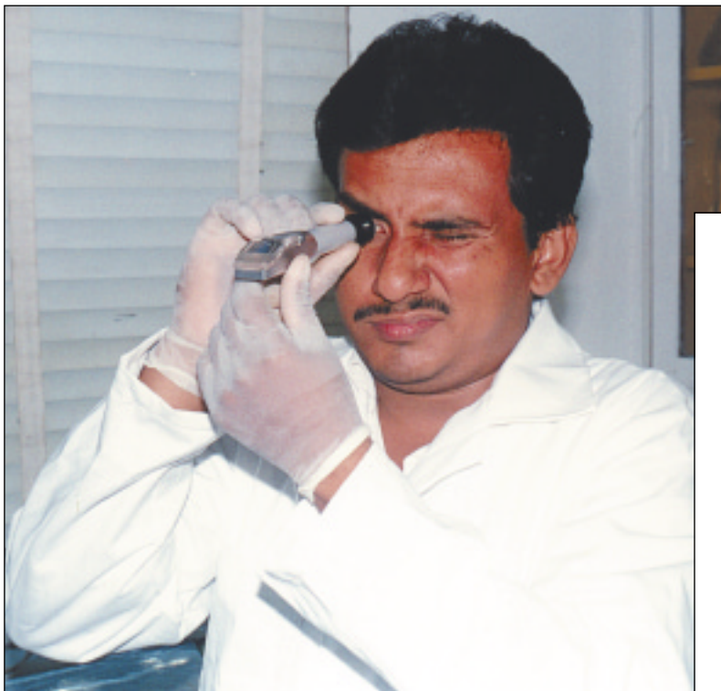
Figure 6: Mesure du taux d'extrait sec soluble à l'aide d'un réfractomètre à main.
