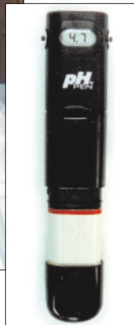
Figure 7: pH-mètre numérique à main servant à mesurer le pH du jus extrait de la pulpe.
