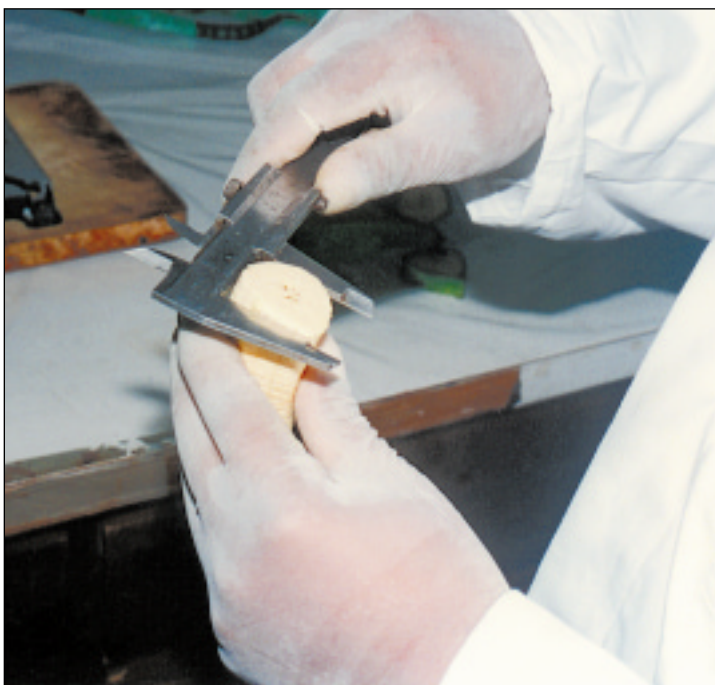
Figure 3 : Mesure de l'épaisseur de la peau et de la pulpe à l'aide d'un calibre.
