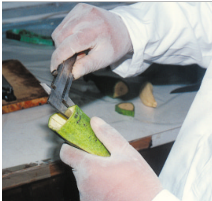
Figure 3 : Mesure de l'épaisseur de la peau et de la pulpe à l'aide d'un calibre.
