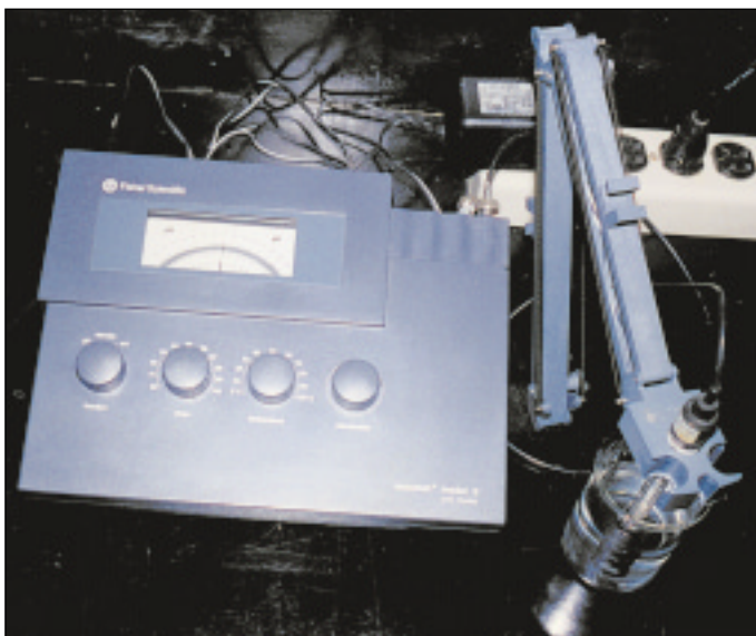
Figure 8: pH-mètre monté sur support servant à mesurer le pH du jus extrait de la pulpe.
