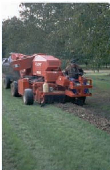
Figure 3.23. Système de récolteuse de fruits secs aux États-Unis. En haut, vibreur. Au centre, rangeuse. Au-dessous, ramasseuse.
