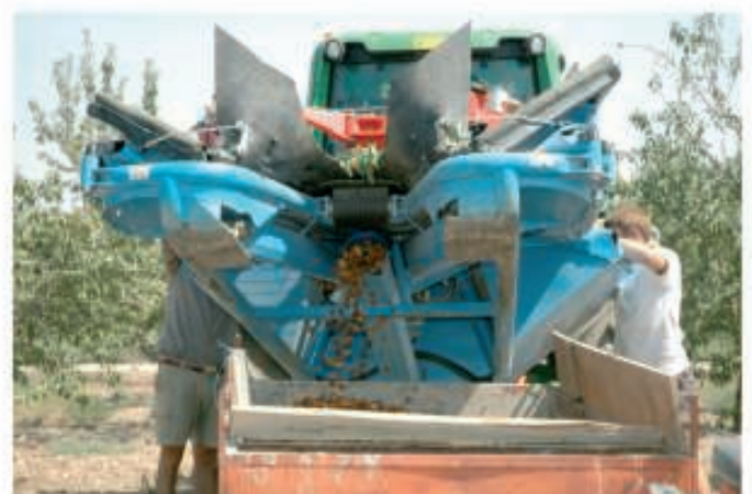
Figure 3.22. Vibrateurs de tronc utilisés pour la cueillette de l'amande. En haut, modèle simple. Au centre, avec parapluie inversé. En dessous, avec parapluie inversé et décortiqueuse.
