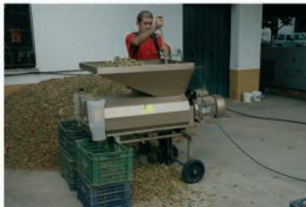
Figure 3.24. Différents modèles de décortiqueuse. Gauche, travaille par la prise de force du tracteur. Droite, fonctionnement électrique.
