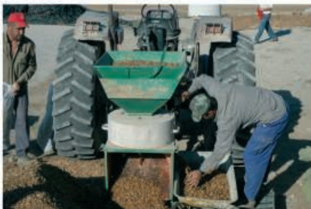
Figure 3.24. Différents modèles de décortiqueuse. Gauche, travaille par la prise de force du tracteur. Droite, fonctionnement électrique.
