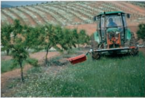
Figure 3.16. Gauche, élimination au moyen d'herbicides de la couverture au moyen d'herbicides. Droite, élimination mécanique au moyen d'un débroussailleur
