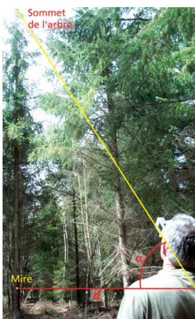
Fig. 7 : Mesure d'une hauteur avec un dendromètre Vertex
