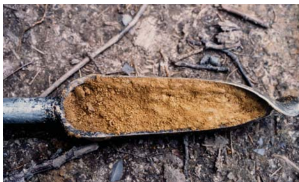
Prélèvement d'une carotte de sol avec la tarière
