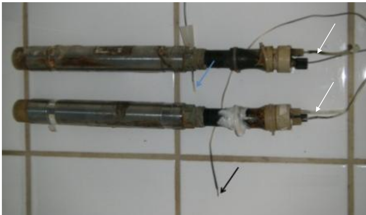
Figure 17: Capteurs potentiométriques sulfure et pH comprenant une électrode de référence (flèches blanches) et une électrode de mesure (flèche bleue pour le pH et noire pour l'électrode de sulfure).
