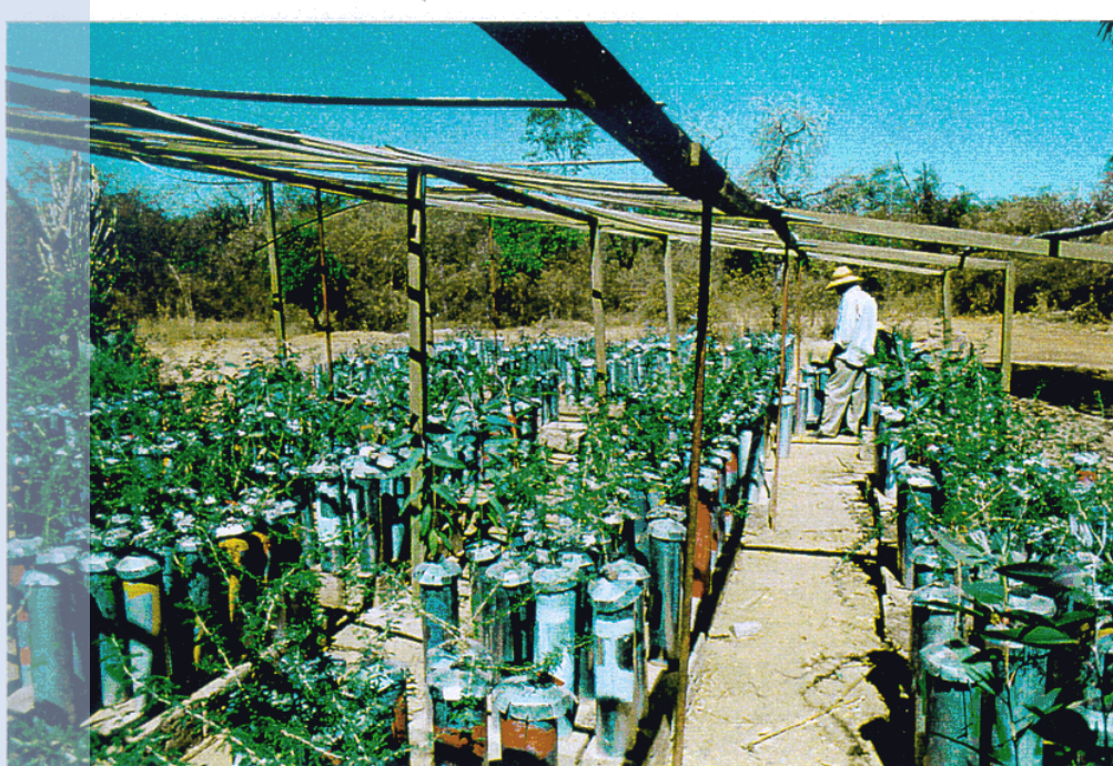
↑ Photo 7 : Dispositif de comparaison de provenances de Faidherbia albida en pépinière. 800 plants de F. albida et d' Eucalyptus camaldulensis en pots, âgés de 4 mois. Les pots sont randomisés, et disposés en "tortue". Le paillage autour des tortues a été retiré pour la photo. L'opérateur mesure la consommation en eau par pesées à l'aide d'une balance électronique portable. INERA-Productions Forestières de Ouagadougou. Décembre 1995.
