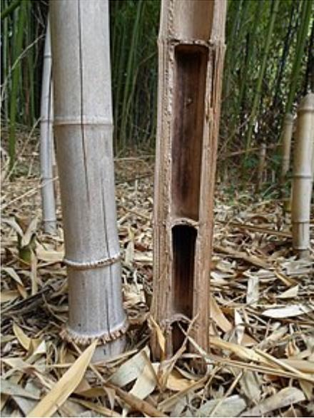
Pied de chaume de bambou, avec une coupe verticale montrant le cloisonnage du chaume.
