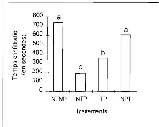
Figure 36 : Temps d'infiltration moyen de l'eau dans les différents traitements. Les parties qui ont les mêmes lettres ont des temps d'infiltration qui ne sont pas significativement différents. NTNP = partie non traitée à la dieldrine et non protégée ; NTP = partie non traitée à la dieldrine protégée ; TP = partie traitée et protégée; NPT = partie non protégée et traitée
