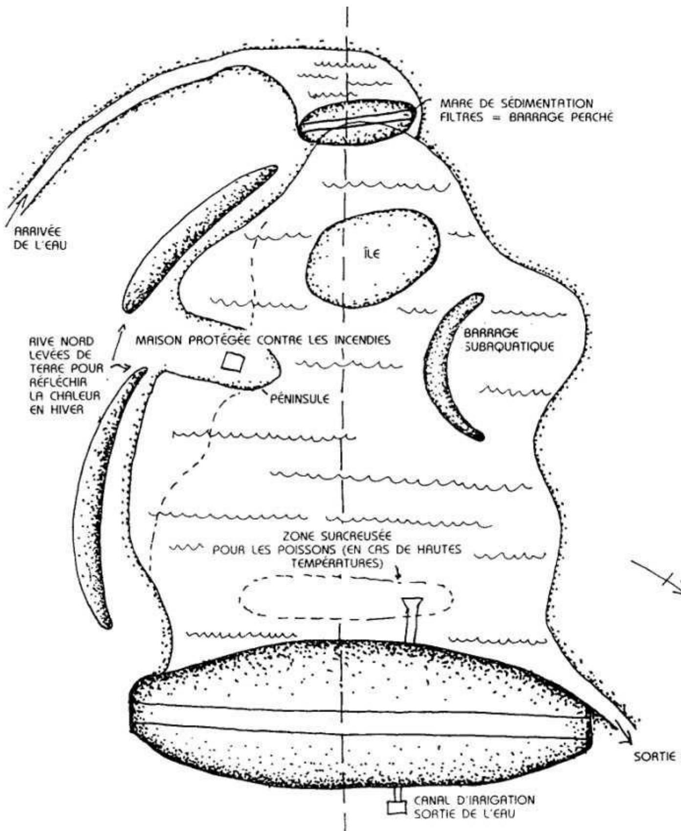
FIG. 7.3 : « COMPLICATIONS » POSSIBLES A PARTIR D'UN BARRAGE CLASSIQUE
