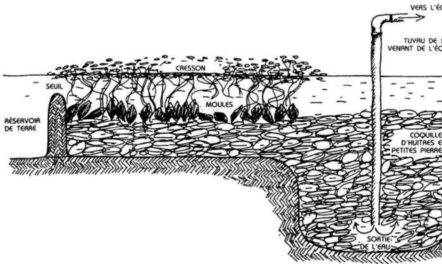
FIG. 7.11: FILTRAGE DE L'EAU. L'EAU VENANT D'UN BARRAGE INFÉRIEUR PASSE A TRAVERS UN CANAL DE FILTRAGE VERS UN RÉSERVOIR DE TERRE (FILTRE BIOLOGIQUE).
