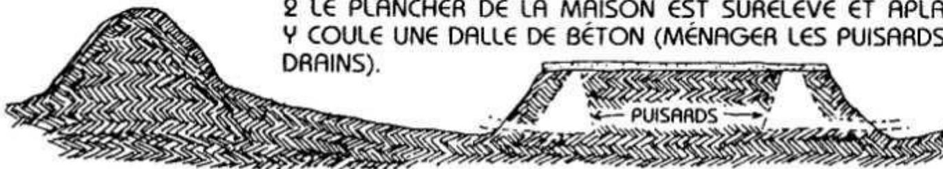
2 LE PLANCHER DE LA MAISON EST SURÉLEVÉ ET APLANI. ON Y COULE UNE DALLE DE BÉTON (MÉNAGER LES PUISARDS ET LES DRAINS).
