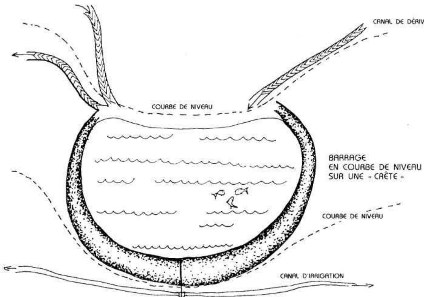
FIG. 7.4 : BARRAGES EN COURBES DE NIVEAU
