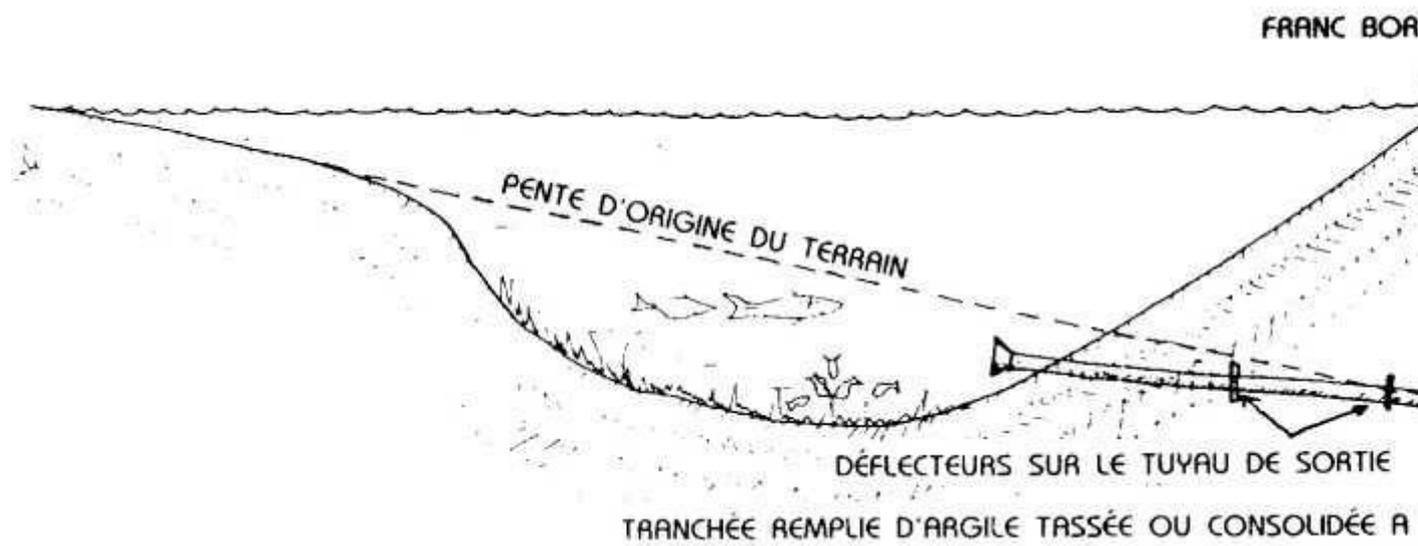
FIG. 7.1 : UN BARRAGE CLASSIQUE (D'APRES YEOMANS2)
