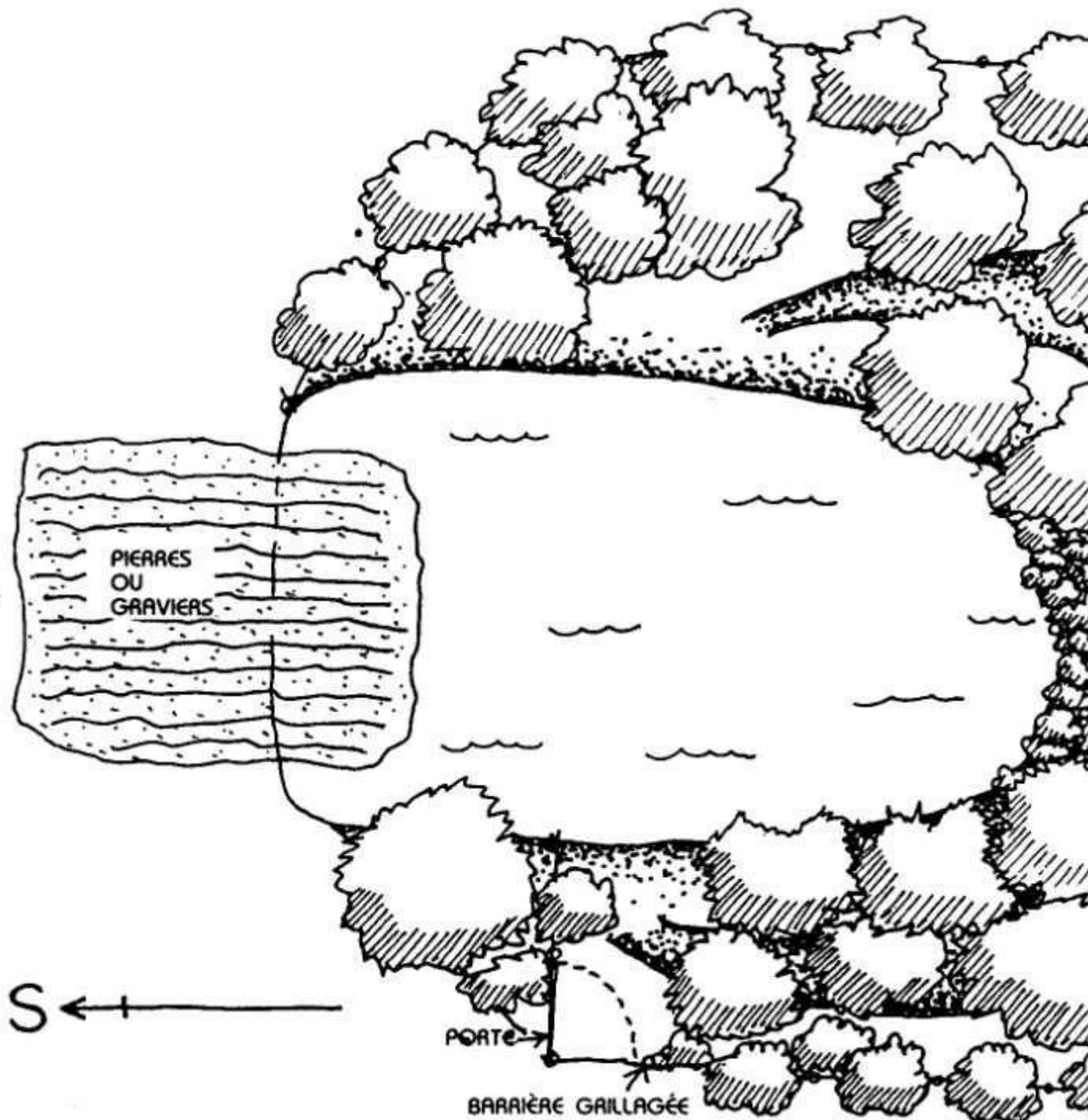
FIG. 7.5 : LEVÉES DE TERRE TYPIQUES DES RÉGIONS PLATES. HABITUELLEMENT SANS PLANTATIONS, PROIE DU VENT ET DE L'ÉVAPORATION. SOUVENT LE SOUS-SOL EST ENTASSÉ SUR LE VERSANT ENSOLEILLÉ ET LE BÉTAIL PEUT APPROCHER
