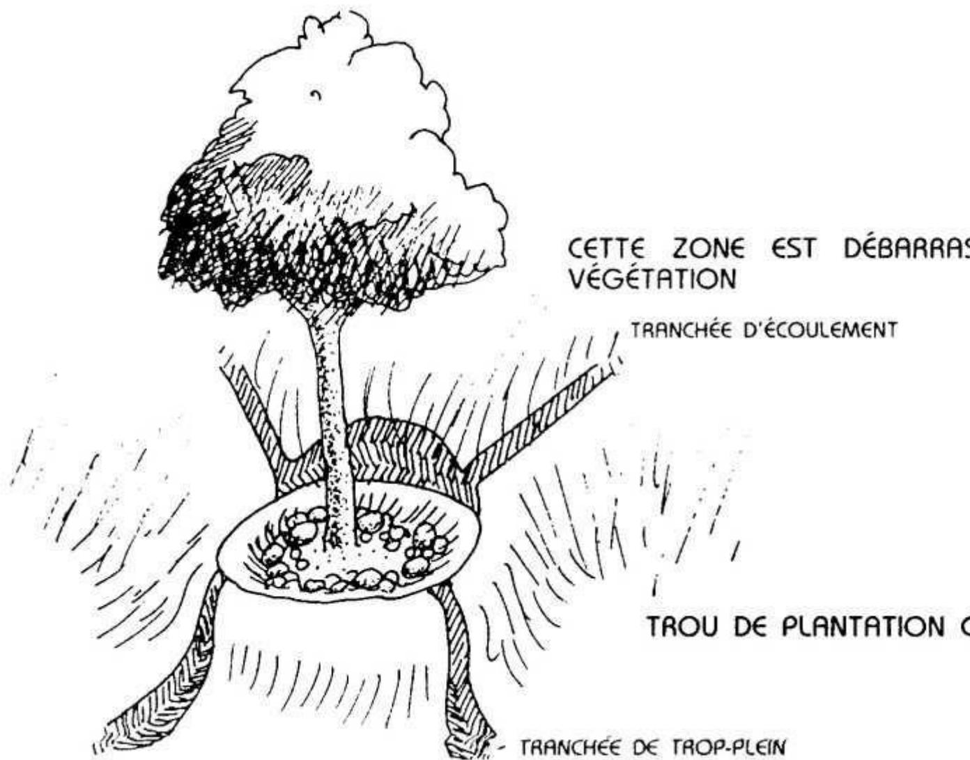
FIG. 5.3 : RÉSEAU ET CUVETTE POUR COLLINE SÈCHE ET PIERREUSE.
