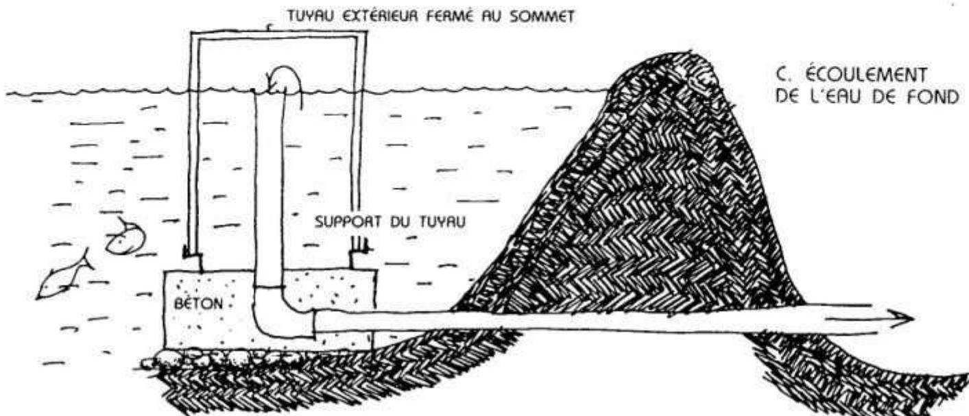
FIG. 7.18 : STRUCTURES DES SORTIES D'EAU DES ETANGS (D'APRES CHAKROFF 16)
