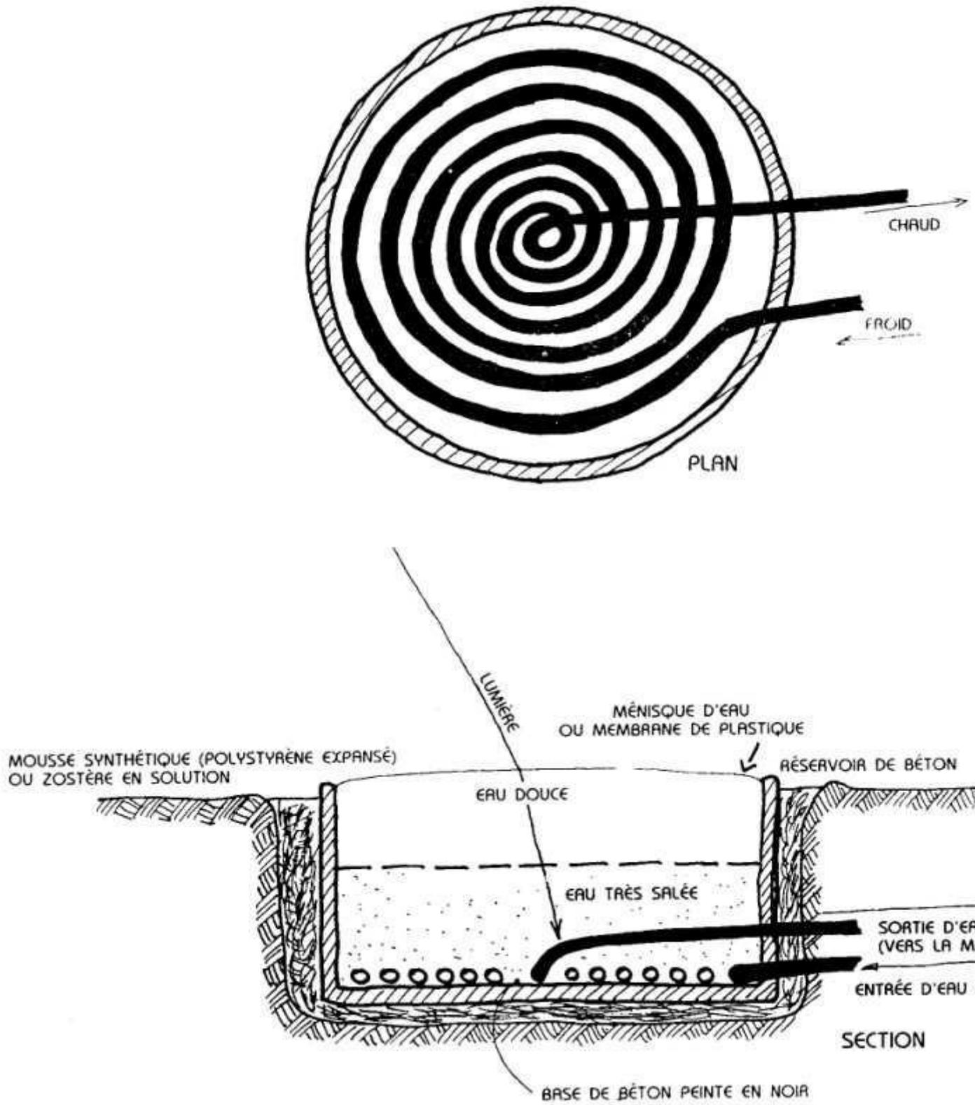
FIG. 7.10: « MARE SOLAIRE ». LA SURFACE COLLECTE LA LUMIÈRE SOLAIRE ET
