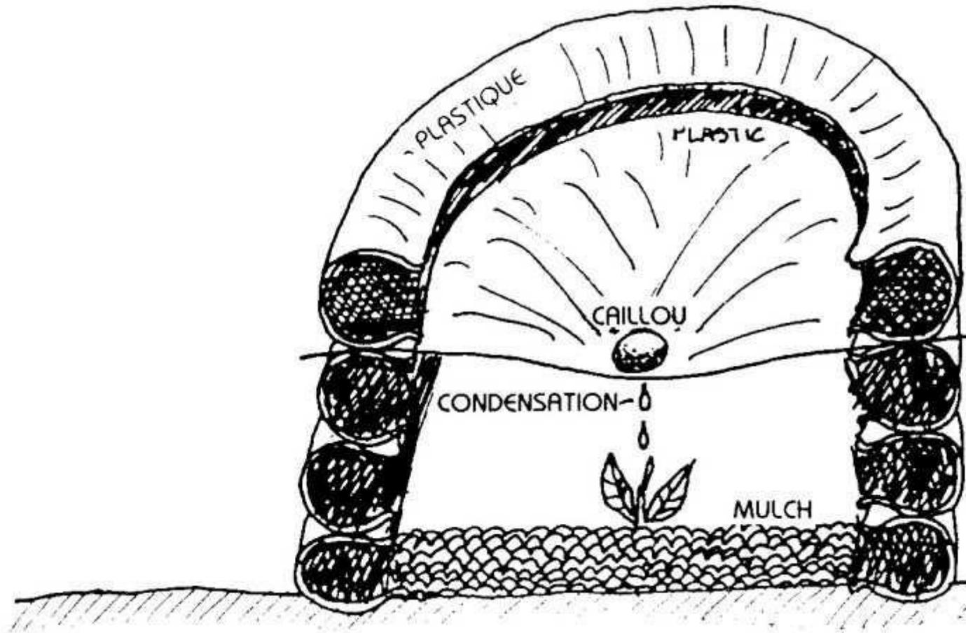
FIG. 5.20: CE CONDENSATEUR EN PLASTIQUE UTILISE DES FEUILLES OU DE LA TERRE POUR CONDENSER L'EAU DU RÉSERVOIR DE LA PLANTE.
