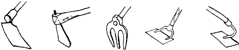
Figure 20 : De gauche à droite : 3 houes à creuser, binette à pousser et binette à tirer
