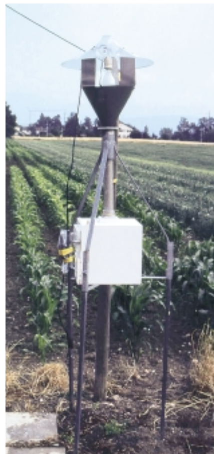
Fig. 1. Piège lumineux utilisé à Changins de 1985 à 2000 pour l'étude du vol de la pyrale du maïs ( Ostrinia nubilalis ).
