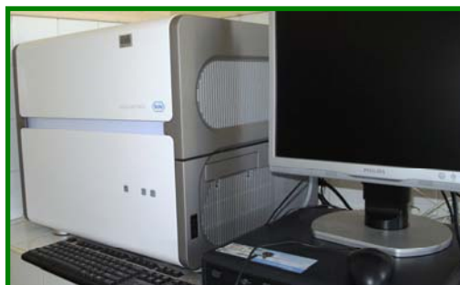
Light cucler 480, PCR en temps réel Appareil acquis par le CRRA Meknes (URPP), Oct. 2009
