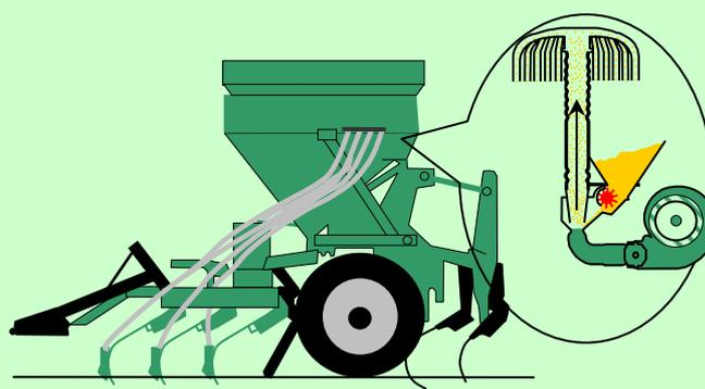
La distribution des graines est de type mécanique (voir ci-contre). Les graines sont ensuite transportées par un flux d'air à grande vitesse, généré par une turbine entraînée par la prise de force, dans des tuyaux souples en plastique.
