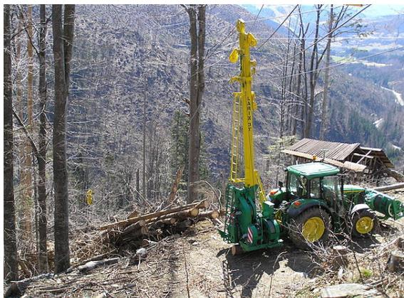
*Câble-mât, utilisé pour la débardage du bois sur les sols sensibles ou dans les montagnes.*
