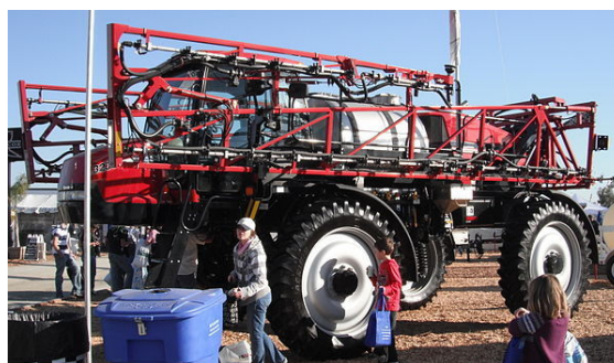
Pulvérisateur autotracteur de grande taille, avec rampes amovibles.
