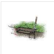
2. Creusement d'une tranchée ou de trous (Au moins 50 cm de prof.)
