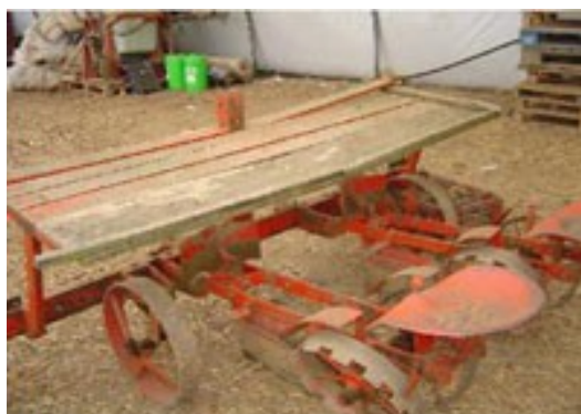
Planteuse polyvalente utilisable pour la plantation de pomme de terre (Possibilité d'y ajouter des roues à godet permettant un travail plus facile et plus régulier)
