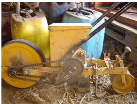
Semoir de précision « EBRA » : le jeu de pignon interchangeable permet une grande précision de semis
