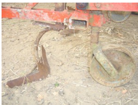
Un élément de la bineuse de précision équipé d'une lame « patte d'oie qui permet de réaliser un léger buttage
