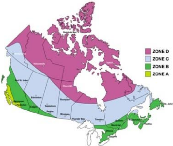
Figure 4. Zones climatiques servant à la spécification des fenêtres
