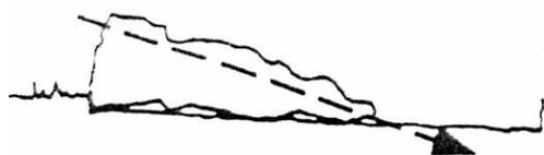
Incliner légèrement les pierres vers l'intérieur du mur pour une meilleure stabilité et favoriser l'écoulement de l'eau.
