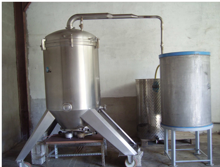
Alambic de 700 litres pour distillation d'huiles essentielles Actuellement en livraison sur le projet CŒUR DE FORET PEROU
