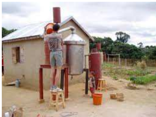
Alambic de la Ferme de Mahatsinjo (150 km au NE d'Antananarivo) pour la production d'huile essentielle. Source : http://www.aboneobio.com/blog/post/2009/03/16/1035-des-huiles-essentielles-de-bio-mada-a-la-realisation-de-creche-et-bibliotheque-a-madagascar
