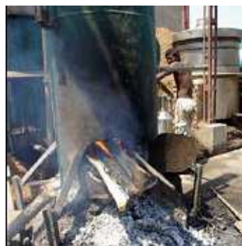
Les 3 chaudières de cette unité de distillation, à Tulear, utilisent du bois devenant de plus en plus cher
